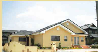
＜吹付け施工例＞3×10板に目地処理を施し、スタッコフレックスサンドフィニッシュを吹付け。
