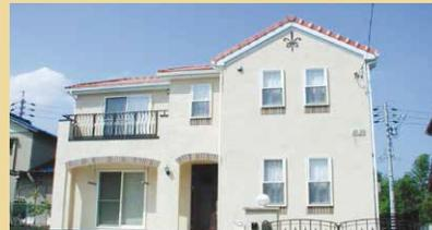
＜コテ塗り施工例＞3×10板に目地処理を施し、スタッコフレックスサンドフィニッシュをコテ塗り。
